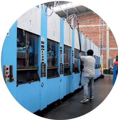
Consiste en el proceso técnico donde se introduce el material EVA en moldes mediante máquinas de inyección. Aquí se forman las suelas y estructuras principales de las sandalias, garantizando precisión en medidas, resistencia y comodidad.
